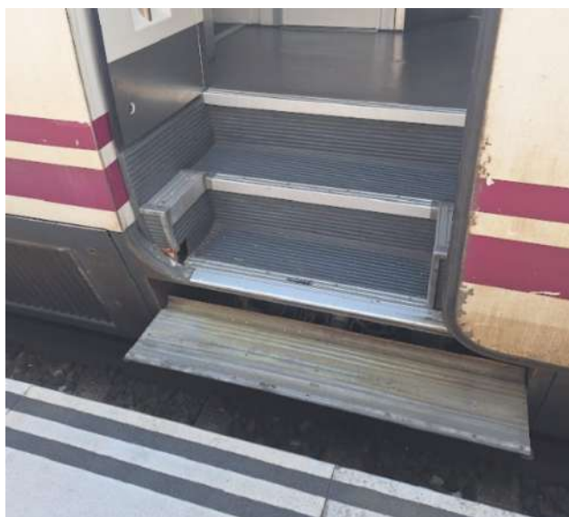
Figura 12. Acceso al vagón mediante escaleras en Zumarraga
